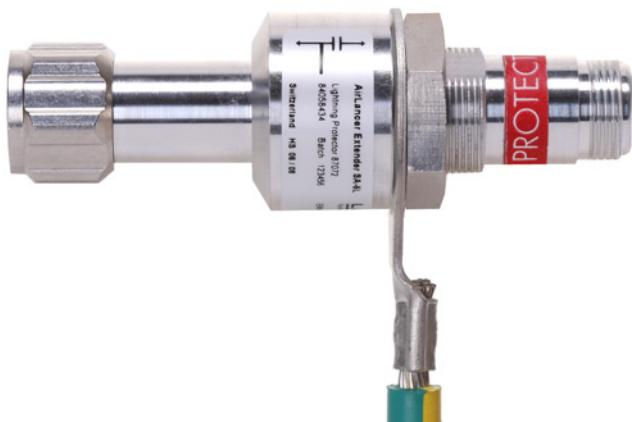
Klemmen Sie zur Erdung des AirLancer Extender SA-5L einen entsprechenden Kabelschuhring mithilfe der Mutter auf der geschützten Seite des Überspannungsschutzadapters fest. Die Erdung wird dann je nach Anwendung wie folgt ausgeführt:
