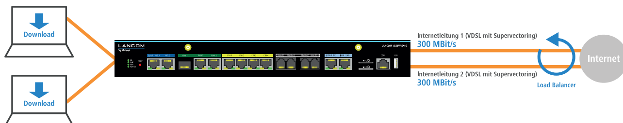
Abb.1: Active/Active-Verband bzw. Load Balancing
